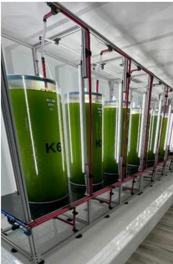
(Izquierda) Las algas se cultivan en tanques de fotobiorreactores con luces LED de cultivo. La fotosíntesis absorbe carbono y libera oxígeno, el único subproducto del proceso de reducción de CO<sub>2</sub> en la producción. *Chlorella vulgaris* es no tóxica y está disponible como aditivo alimentario.
