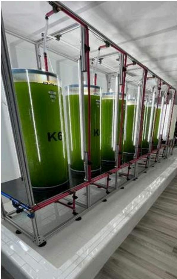
(À gauche) Les algues sont cultivées dans des photobioréacteurs équipés de lampes de croissance à LED. La photosynthèse absorbe le carbone et libère de l'oxygène, le seul sous-produit de la production étant la diminution du CO<sub>2</sub> au cours du processus.
